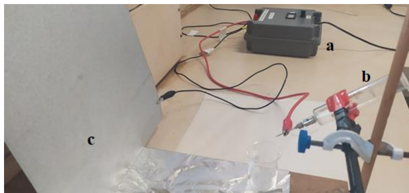
Figura 9: Sistema de eletrofiação: a) fonte de alta tensão; b) seringa (polo negativo); c) coletor (polo positivo).
