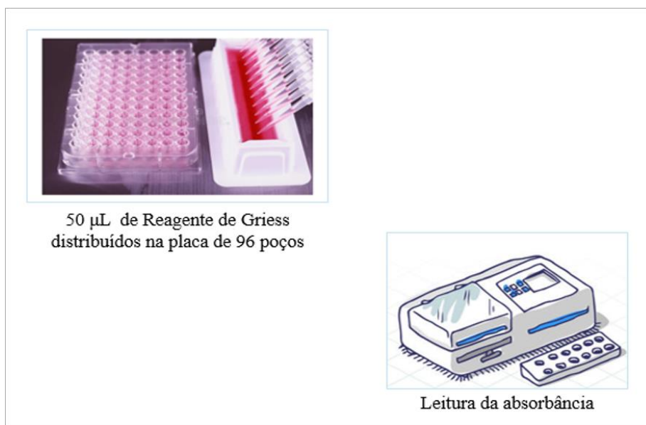
Figura 5. Esquema representativo da reação de diazotação com o reagente de Griess. Fonte: Google Imagens.
