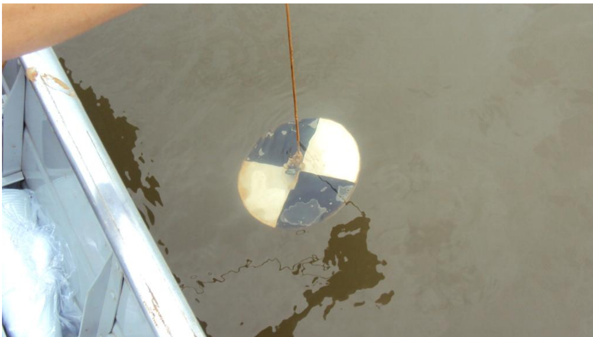
Foto 5 - verificação da transparência de Secchi
