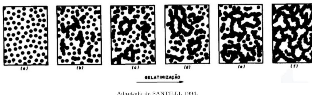
Figura 2.11: Esquema do processo de gelatinização das partículas dispostas em um meio coloidal a partir do método sol-gel de produção de nanomateriais.
