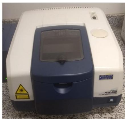
Figura 3.8: Equipamento de medidas de Espectroscopia na Região do Infravermelho JASCO FT/IR-4100.
