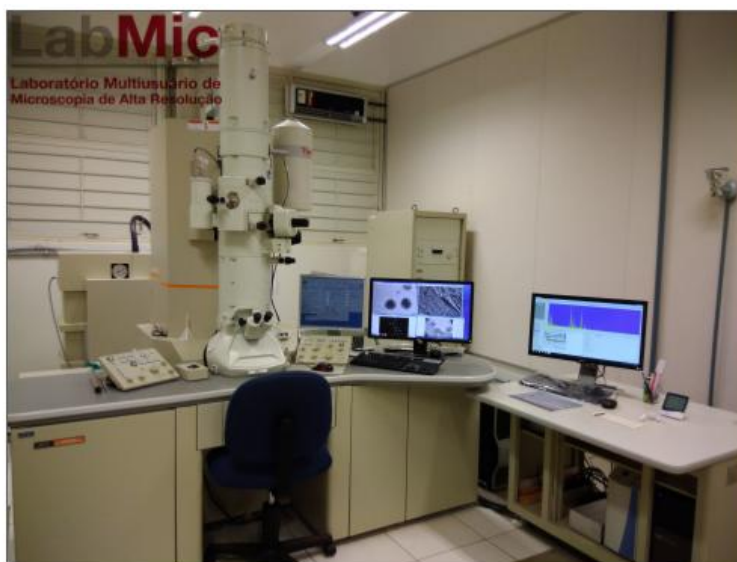
Figura 3.10: Microscópio Eletrônico de Transmissão (MET), JEM-2100, Jeol, Tokyo, Japan, equipado com EDS, Thermo scientific.
