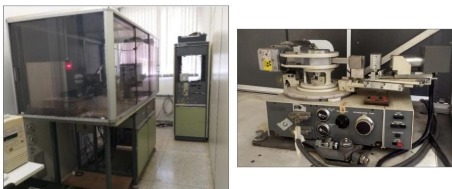
Figura 3.12: Difratômetro de Raios-X da marca Rigaku XGC - 30, utilizado nas obtenção de dados de Difração de Raios-X.
