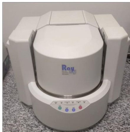
Figura 3.6: Aparelho para análise de Fluorescência de Raios-X - Ray Ny EDX-720 da Shimadzu.
