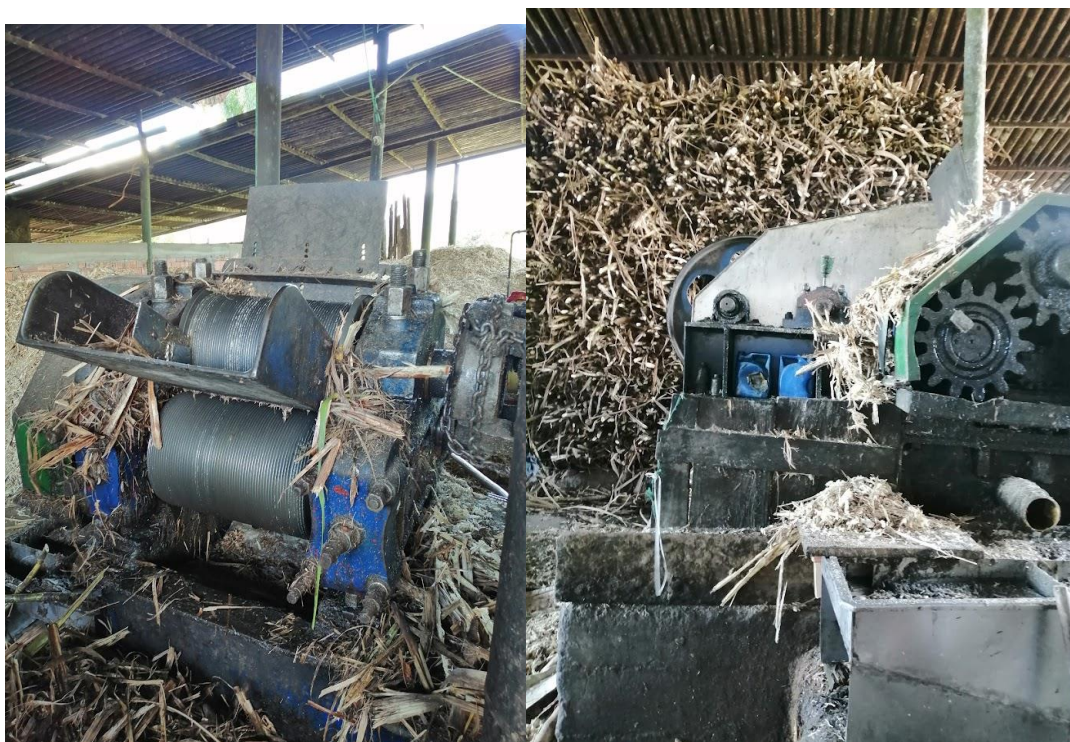
Foto 10 - “Mete caña”- extração do caldo da cana
