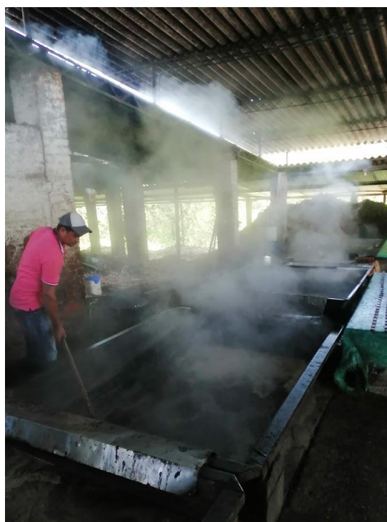
Foto 12 - Processo de “Segundo” em trapiche paneleiro tradicional – San Benito
