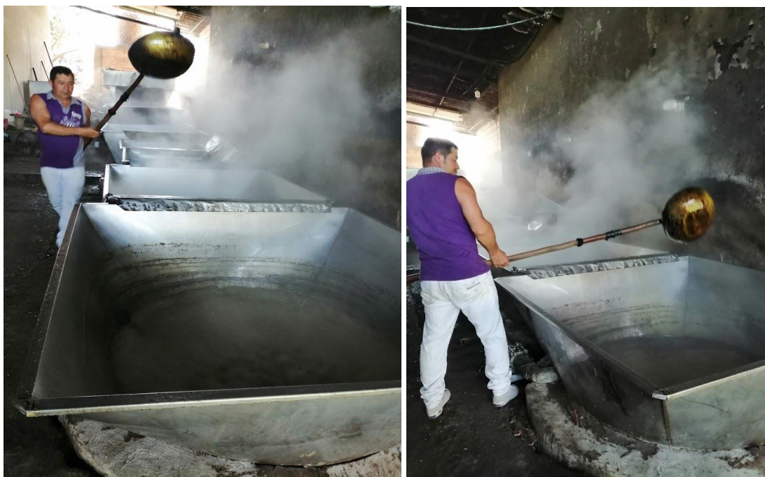
Foto 13 - Processo de “el batido” em trapiche paneleiro tradicional - Güepsa
